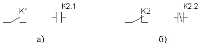
Рисунок 3.4 – Графическое обозначение контактов в языке LD (слева) и соответствующее им общепринятое обозначение
