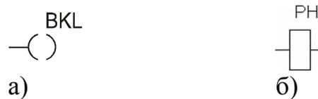
Рисунок 3.7 – Графическое обозначение а) – витка в языке LD; б) – реле
